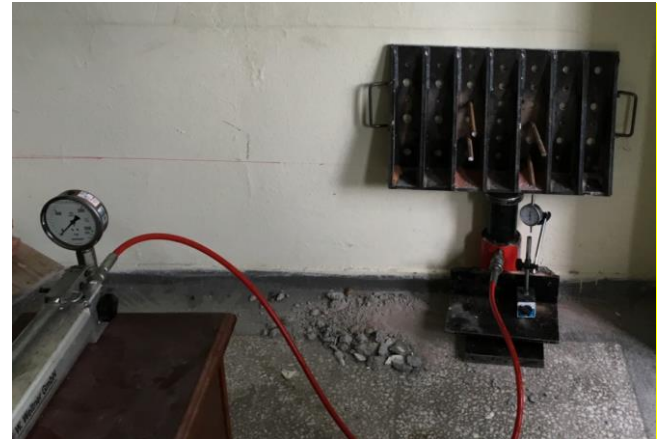
Şekil 3. Ankraj Donatısı Kesme Performansı Deney Düzeneği
