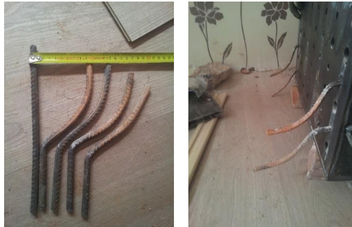
Şekil 4. Ankraj çubuklarının duvar içerisinde göçme şekli
