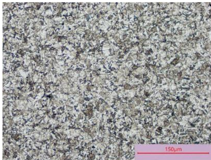
Şekil 6. Çalışmada kullanılan ultra yüksek mukavemetli S960QL çeliğinin TM + B'den oluşan mikroyapı fotoğrafı.
