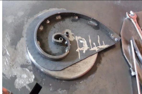
Fotoğraf 2. P044 mamulü Parça 126/1-2 için yeni oluşturulan yeni büküm kalıbı
