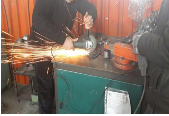
Fotoğraf 1. Büküm makinesine uygun kalıp yapımı (P044)
