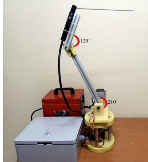
Şekil 2. Robotik kolun mafsıl ve açıları (Joints and angles of the robotic arm)
