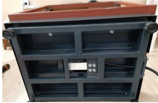
Şekil 3. Tartım platformu ve ağırlık ölçerin montaj edilmiş görünümü
