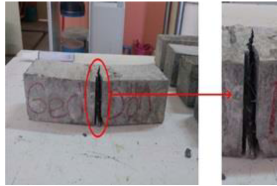
Şekil 5. Kırılma bölgesinde köprü görevi gören çelik lifler
