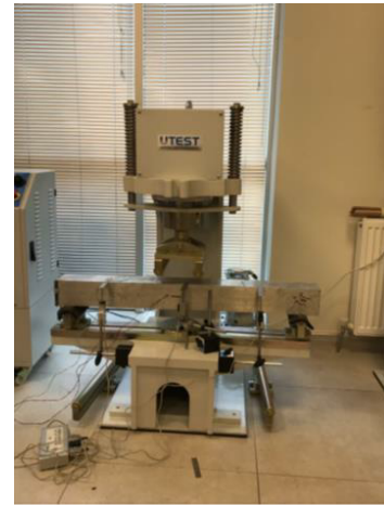
Şekil 1. ATBD kirişlerin dört noktalı yükleme altında deney düzeneği
