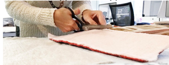
Resim 5 Ön keçeleştirme işlemi yapılan elyaf bantlarının kesilerek şerit elde edilmesi.
