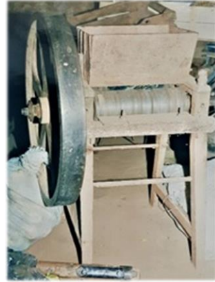
Görsel 7. Kilin inceltilmesi için kullanılan vals.
