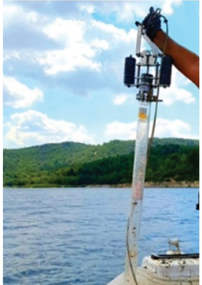
FotoĖraf 2. Kajak sediment   rnekleycisi. Photo 2. Kajak sediment sampler.
