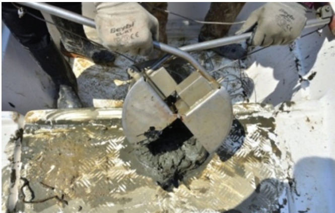
FotoĖraf 1. Van Venn Grab ile y  zey sedimenti   neĖi alınması. Photo 1. Sampling of surface sediment with Van Venn Grab.
