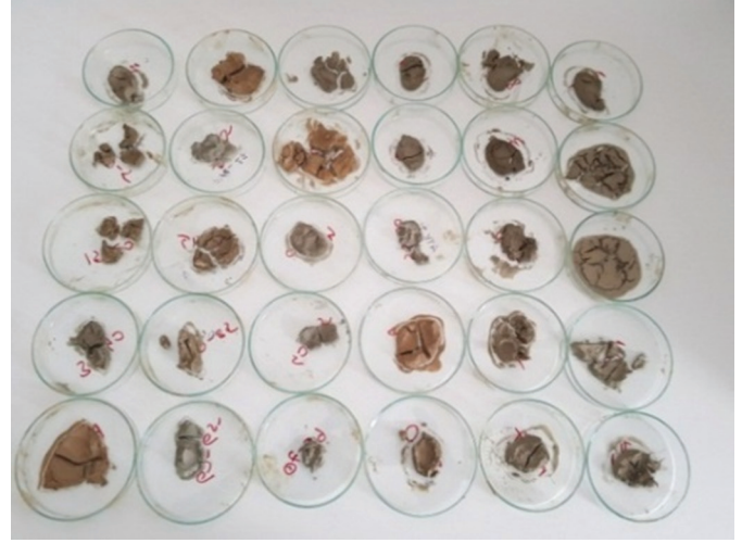
FotoĖraf 9. Et vde 60  C'de 24 saat kurutulmu  sediment  rne leri. Photo 9. Sediment samples dried for 24 hours at 60  C in an oven.
