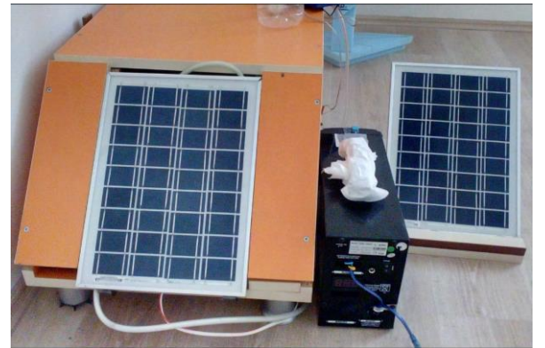
Şekil 2. Panel deney düzeneği. Sol taraftaki panel tabanı bakır boru sistemli, sağ taraftaki soğutmasız panel.
