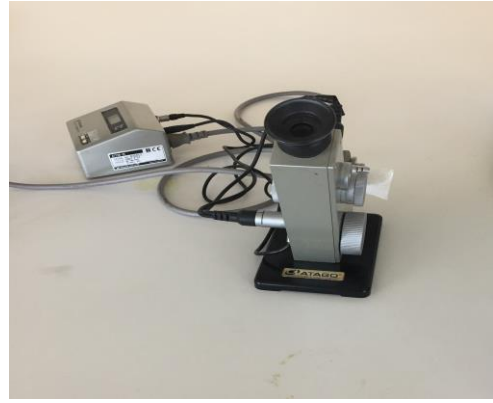
Şekil 2. Ölçümde kullanılan abbe refraktometresi
