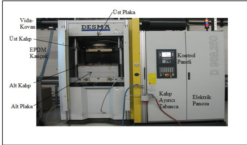
Şekil 4. Deneyin gerçekleştirildiği DESMA enjeksiyon makinesi
