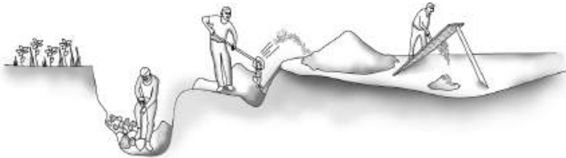
Resim 4. Toprağın Alt Katmanlardan Alınması, Elenmesi ve Kurumaya Bırakılması Süreci
