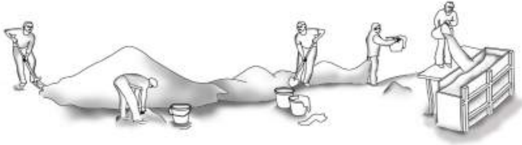
Resim 8. Karışımın Kalıpla Doldurulması ve Sıkıştırılması Süreci
