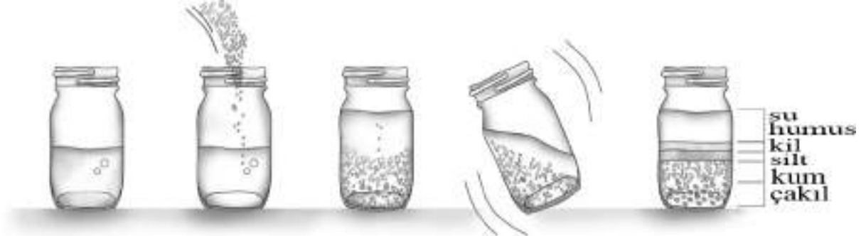
Resim 5. Toprak Bileşenlerinin Analiz Edilmesi Deney Düzeneği
