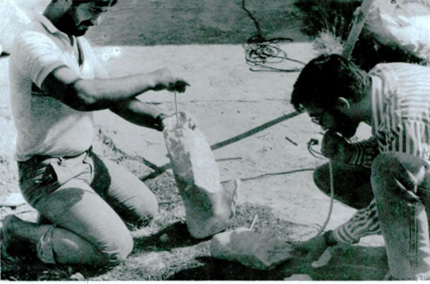
Res. 37 — Kıvrılabilen hortum kullanarak delik iinin temizlenmesi.
