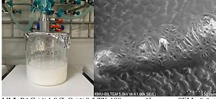
Şekil 3. PAG / %1,0 ZnO / %0,5 TX-100 nanoyağlayıcının SEM görüntüsü
