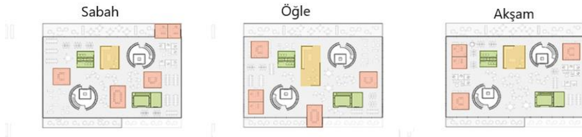
Şekil 5. Gün boyunca mekânları yeniden düzenleyen yapının esnekliğini gösteren çizimler [11]
