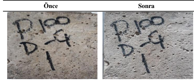
Şekil 9. Numunelerin donma çözünme etkisindeki görsel değişimi
