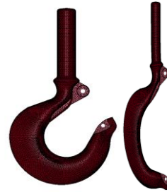
Şekil 10. Statik testten önce ve sonra 2TAK modeli
