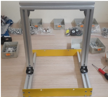
Şekil 5. Alüminyum sigma profiller ile oluşturulan gövde
