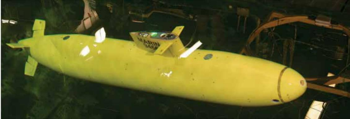
**Şekil 12.** Max "q" manevrası yapan serbest hareketli BB2 modeli (Overpelt et al., 2015).
