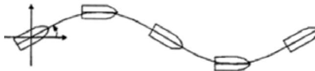
**Şekil 16.** Düzlemsel hareket mekanizmasının hareket modları (Can, 2014).
