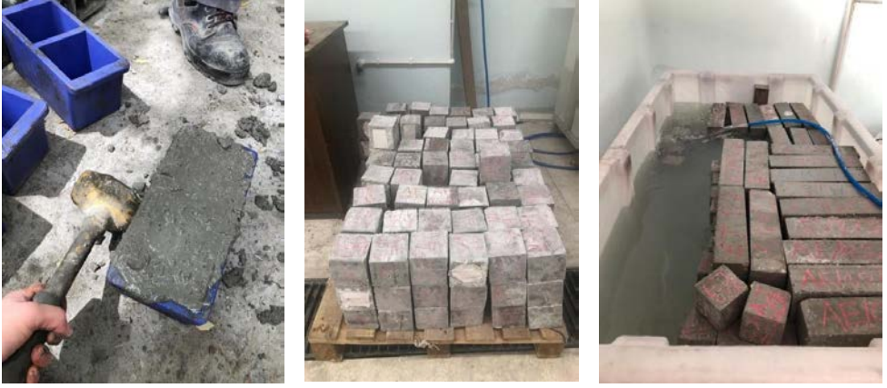
Şekil 2. Numunelerin yerleştirilmesi, kalıptan çıkartılması, kür havuzuna yerleştirilmesi
