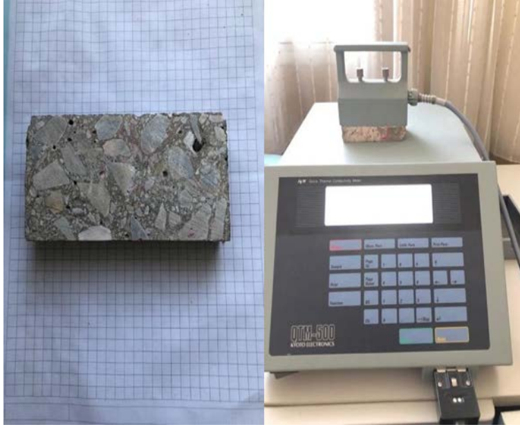
Şekil 14. Isıl iletkenlik deneyi için kesilen numune ve ısıl iletkenlik deney aleti
