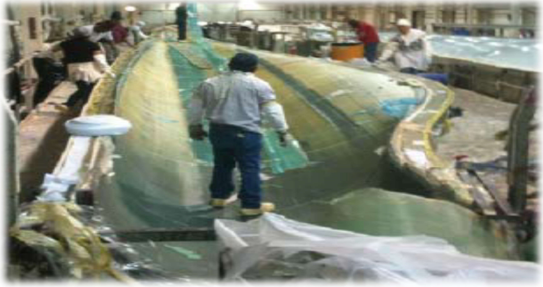
Şekil 3. İnfüzyon işlemi sonlanmış bir kanat görüntüsü (Karabağ, 2011). Figure 3. Photograph of a wing after the infusion process (Karabağ, 2011).
