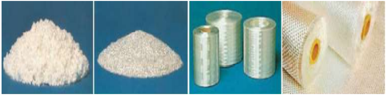
Şekil 1. Cam takviye yapının morfolojik örnekleri: öğütülmüş, kırılmış, fiber ve dokuma kumaş (soldan sağa) (Sönmez ve Şatır, 2009)
