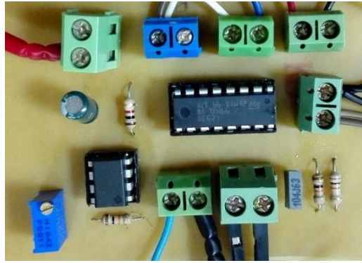
Şekil 4. Sinyal kuvvetlendirici ve kontrol devresi
