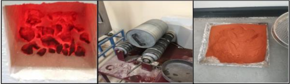
Şekil 3. Terra rosa malzemesinin kalsinasyon ve öğütme süreçleri
