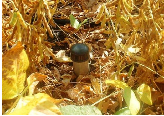
Şekil 7. Nötronmetre ölçümlerinin gerçekleştiği alüminyum tüp [40].
