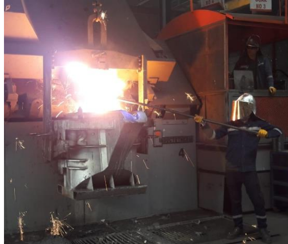
Şekil 11. Pota aşılama yöntemi
