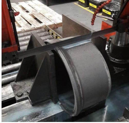
Şekil 14. Çekme ve mikro yapı için numune alma
