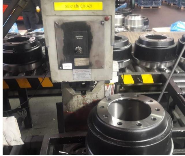
Şekil 22. Brinell sertlik ölçme cihazı
