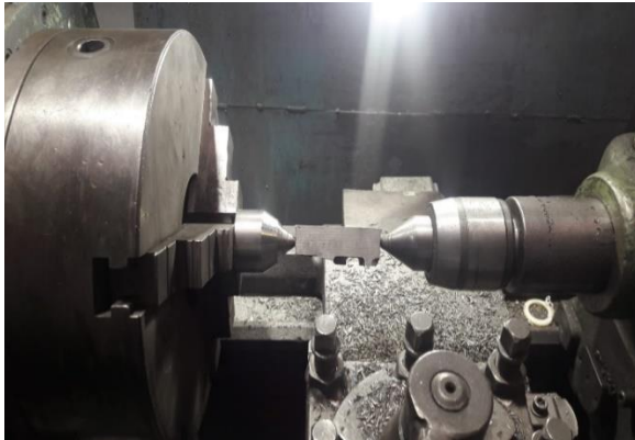
Şekil 16. Torna da işlenen çekme çubuğu
