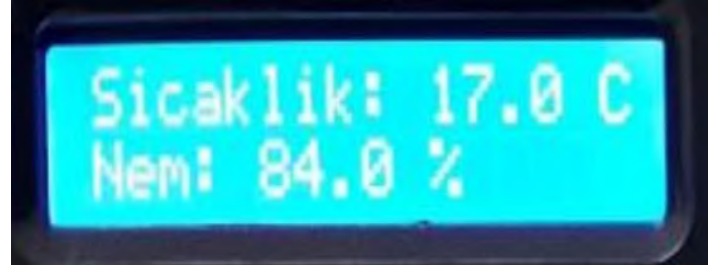
Şekil 3.2. I2C LCD Ekranda sıcaklık ve nem bilgilerinin gösterimi
