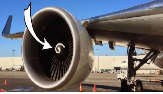
Şekil 10. Uçak motorlarında kullanılan döner spiral örneği [Hoke, 2015].
