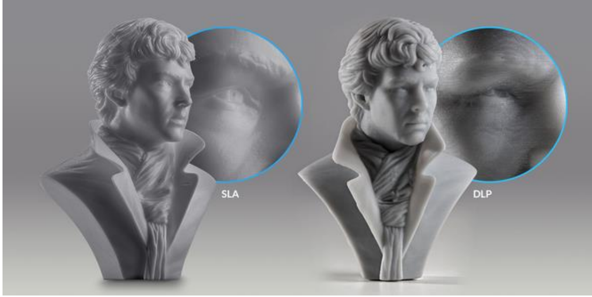
Şekil 4. SLA ve DLP yöntemiyle üretilmiş parçaların karşılaştırılması [33]
