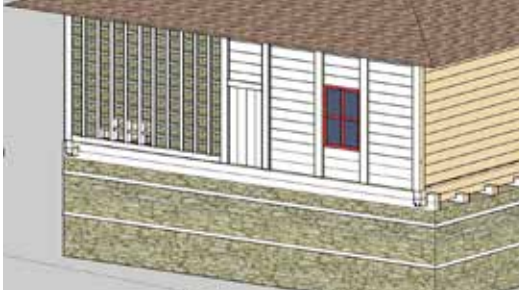
G. 10: Ahşap karkas sistemde göz dolma tekniği (Çizim: Özlem Karakul)
