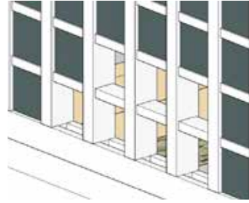
G. 10: Ahşap karkas sistemde göz dolma tekniği (Çizim: Özlem Karakul)
