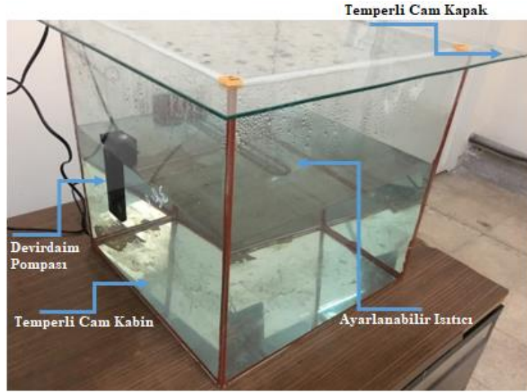
Şekil 3. Yaşlandırma kabini ve komponentleri
