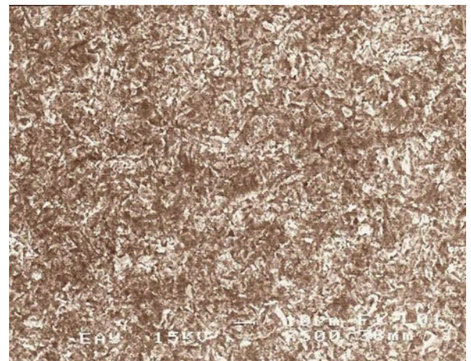
Şekil 6: Elmas frez ile pürüzlendirilen Co-Jet uygulanan örnek (×500)
