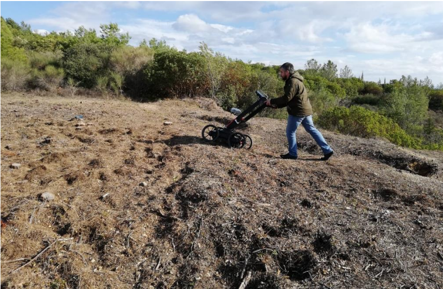
Şekil 2. Çalışmada kullanılan 450 MHz HDR anten ile yeraltı radarı (GPR) uygulaması
