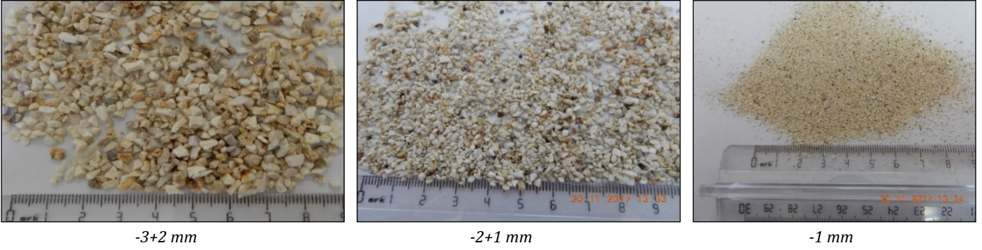
Şekil 2. Sarsıntılı masa testlerinde elde edilen konsantrelerin fotoğrafları
