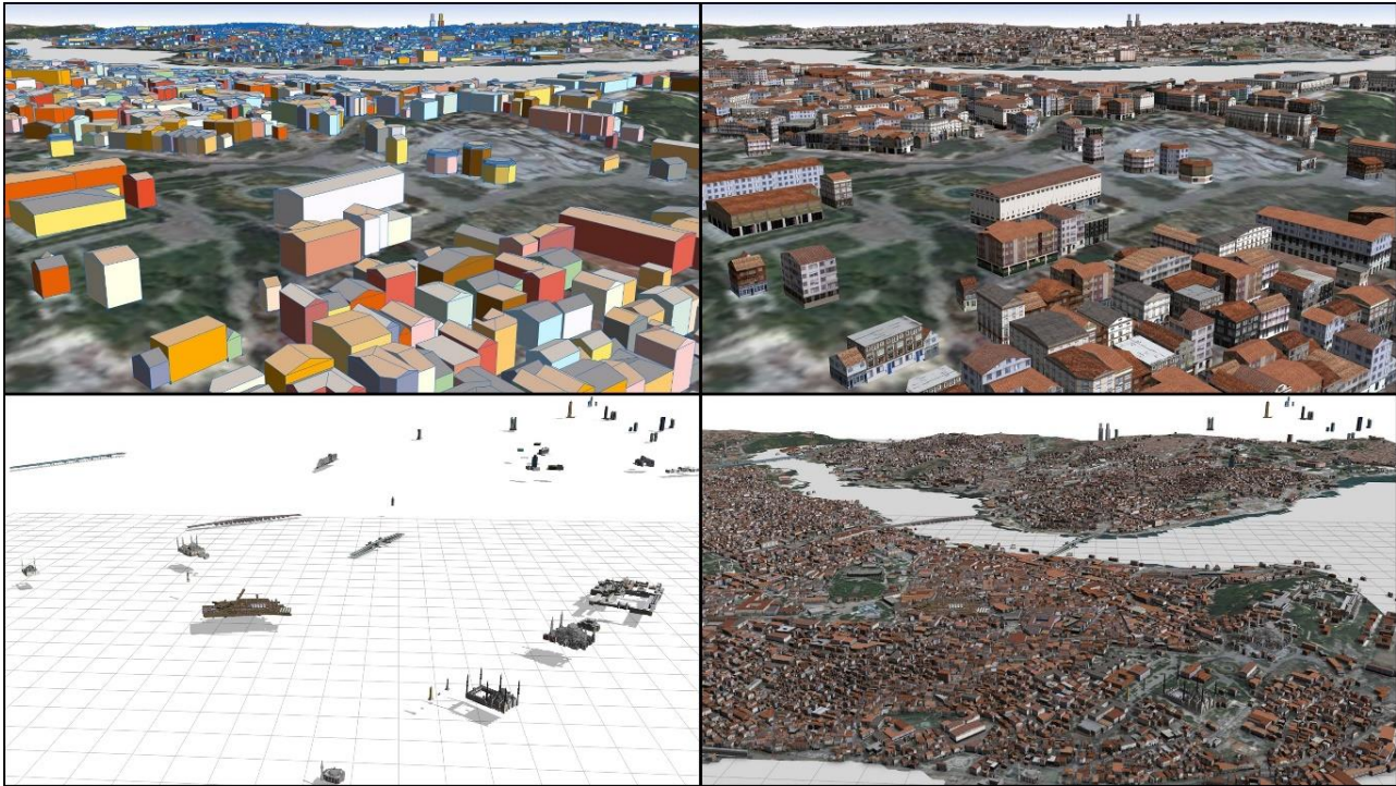
Şekil 5. Tarihi Yarımada bölgesine ait: Prosedürel olarak üretilen LOD2 seviyeli bina modelleri (sol üst); Prosedürel olarak rastgele cephe kaplamalı üretilen LOD2 seviyeli bina modelleri (sağ üst); Proje alanı ve yakınlarında bulunan kentsel sembolik yapı modelleri (sol alt); Entegre edilen tüm veriler ile Tarihi Yarımada bölgesi tasarımı (sağ alt)
