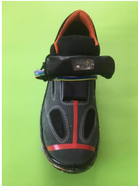
Şekil 5. Açık ve Kapalı Alanlarda Elektrik Kaçak Tespiti için İş Ayakkabısı Tasarımı ve Prototip Üretimi
