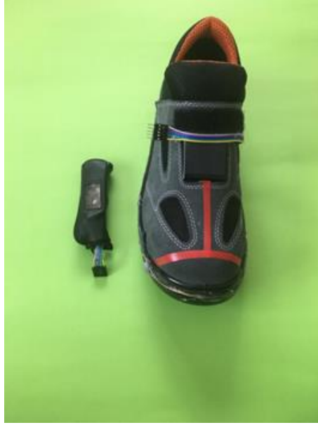
Şekil 6. Elle Sökülüp ve Takılabilen Kontrol Ünitesi
