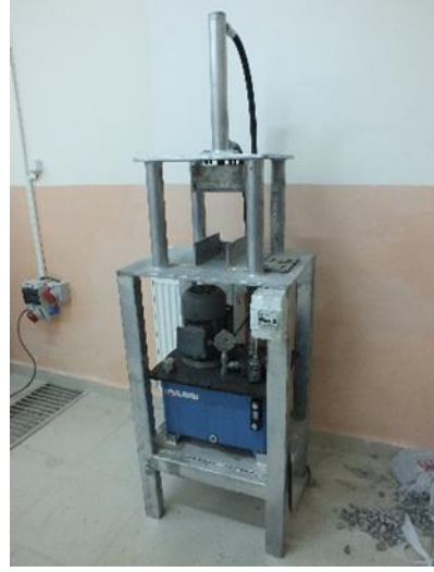
Görsel 9. 100 Bar sıkıştırma kapasiteli pres
