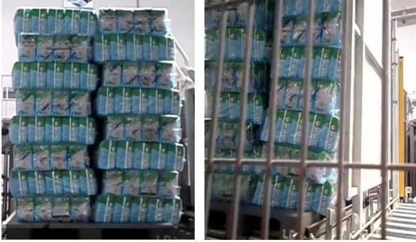
Şekil 2. Palet üzerinde dizim sırasında torbaların birbirinden ayrılması (Kapucu ve ark., 2019 a )
