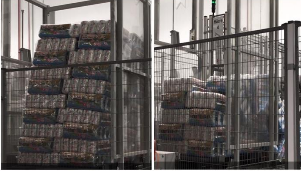
Şekil 1. Taşıma arabasının ivmelenmesine bağlı olarak devrilmeler (Kapucu ve ark., 2019 a )
