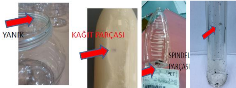
Şekil 4. Yabancı madde kaynaklı hatalar
