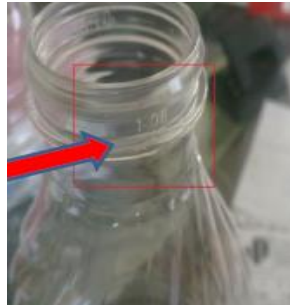
Şekil 10. Şişe ağzında deformasyon
