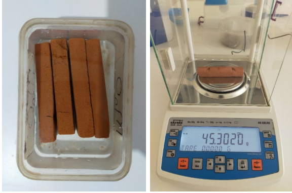
Su Emme Testi İçin Yapılmış Deneme Çubukları
