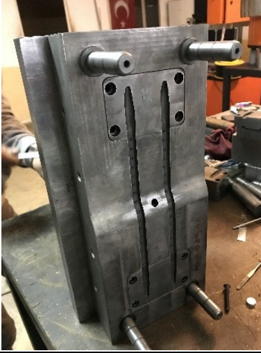
Şekil 3.e: Tek kullanımlık Dilatatör için plastik enjeksiyon kalıbının sabit plakası
