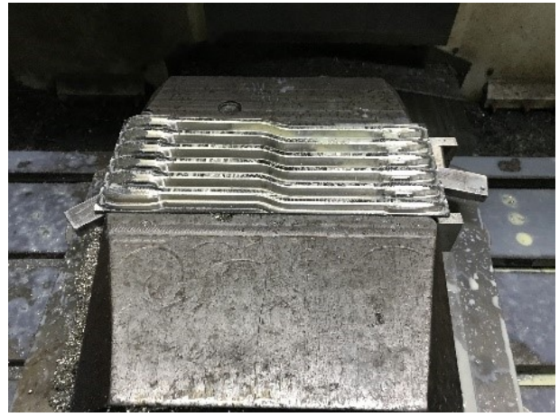
Şekil 2.b: Dik işleme merkezine bağlı, kaba işlemesi bitmiş durumda
