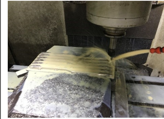
Şekil 2.a: Dik işleme merkezinde işlenirken
