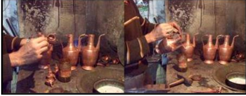
Fotoğraf 20. İbriğin (Upruğun) Kapak, Kulp, Emzik ve Dip Kısımının Lehimlenerek Takılması
