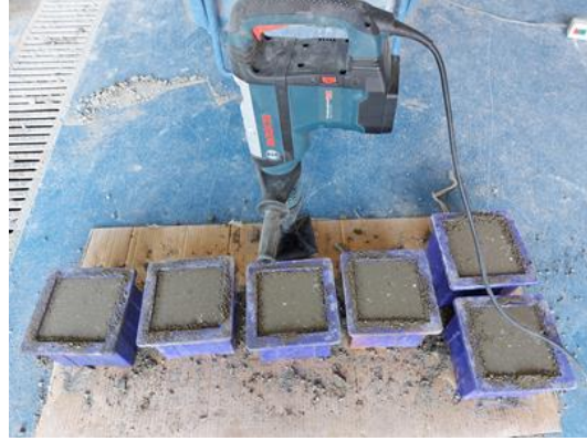
Şekil 2. Kalıplarda sıkıştırılmış SSB örnekleri Figure 2. RCC specimens in molds
