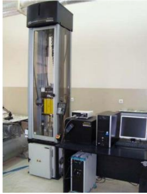
Şekil 1. Instron-Dynatup 9250 HV darbe dayanım test cihazı.
