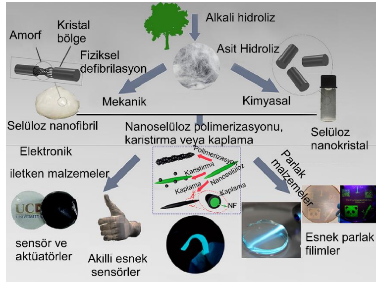
Şekil 1. Selülozik nanoliflerin elde edilmesi ve uygulama alanları (Trache ve ark. 2020)
