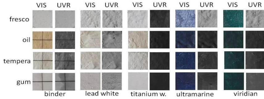
Şekil 13. Farklı Bağlayıcı Türlerine Göre Çeşitli Pigmentlerin UVR Sonucu(Kaynak: Cosentino, 2015b: 295)
