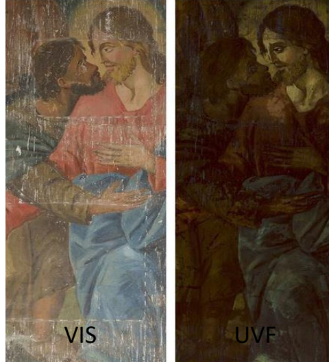
Şekil 10. VIS: Görünür Bölge, UVF: Ultraviyole Floresansı Acı Sant'Antonio'daki (Sicilya) Ana Kilise'nin Haç Şapeli'ndeki Fresconun UVF Sonucu Secco Tekniğine Ait Floresansı Kaynak: (Cosentino, 2015a: 58)
