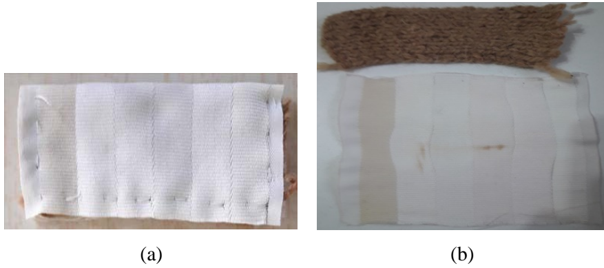
Şekil 10. a; Yıkama haslıđı testi için (Kavrulmuş fıstık kabuđu ile boyanmış) çok lifli refakat bezi arasında kumaş, b; test sonrası kumaş ve refakat bezi.
