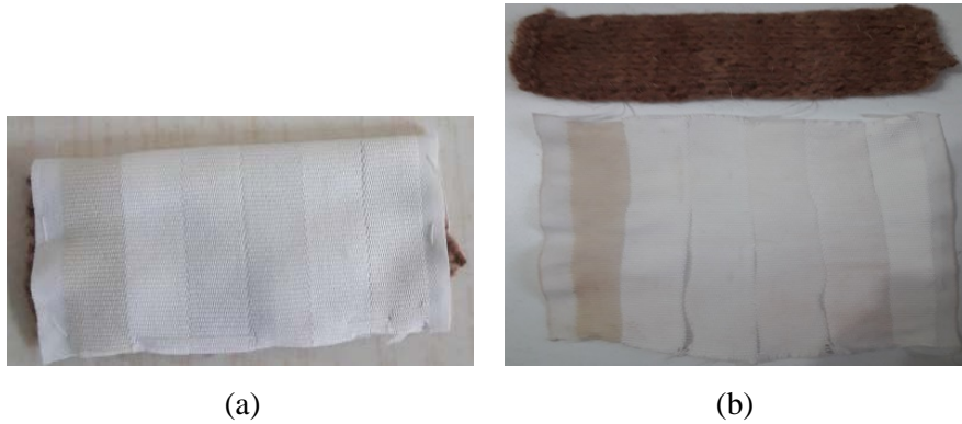
Şekil 11. a; Yıkama haslıđı testi için (Ham fıstık kabuđu ile boyanmış) çok lifli refakat bezi arasında kumaş, b; test sonrası kumaş ve refakat bezi.
