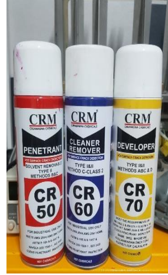
Şekil 2. Sıvı penetrant yönteminde kullanılan malzemeler.
