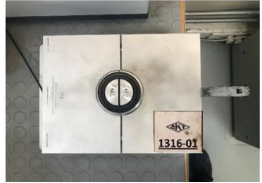
Şekil 6. Pinyon keçesi radyal kuvvet ölçüm cihazı
