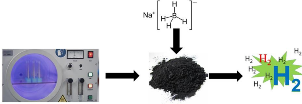
CO 2 gazı ortamında %80 plazma gücü ile 15 dk plazma etkisi
