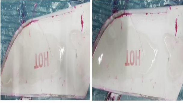
Şekil 6. Drain mast komponentinin penetrant uygulaması ile muayenesi.
