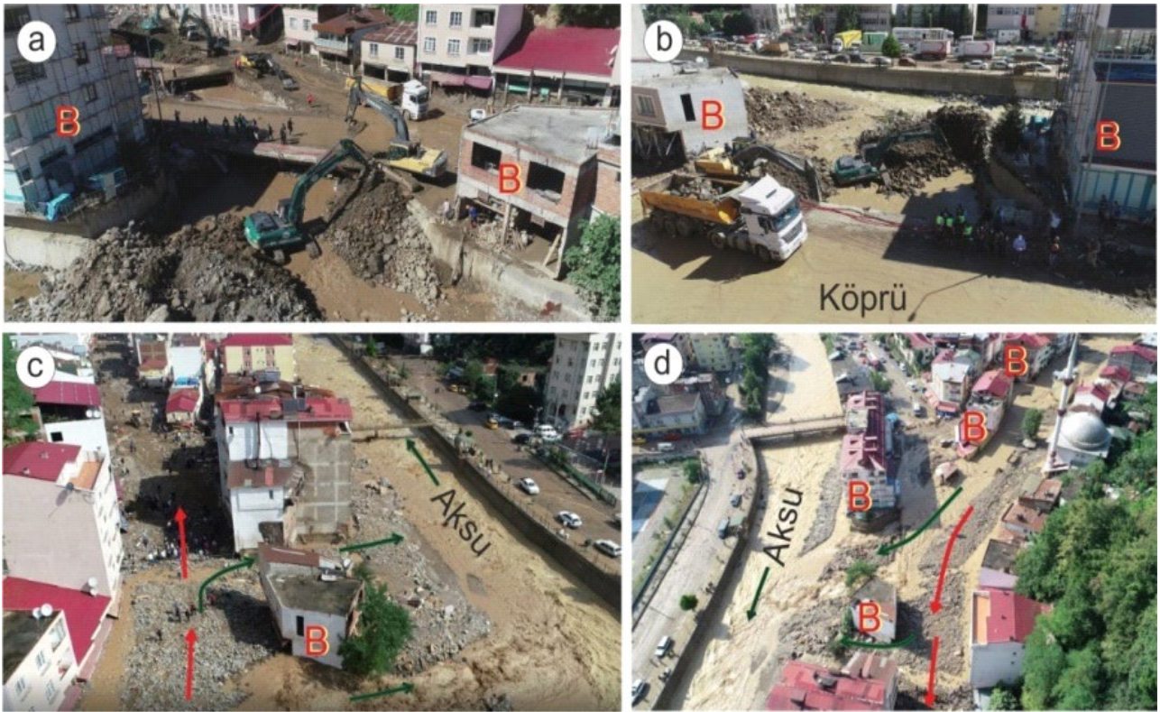
Şekil 16. Tıkanan köprülerle birlikte, sediment yüklü derenin ilçeye yönelmesinde (kırmızı oklar) etkili olan binaların (B işaretli) çeşitli açılardan görüntüleri (fotoğraflar DSİ 226. Şube).
