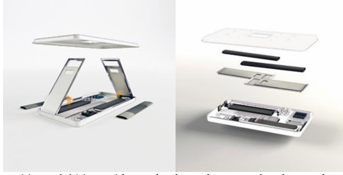
Şekil 38. Designnobis geçici bireysel barınak sıkıştırılma süreci ve katmanları (mimarizm.com)
