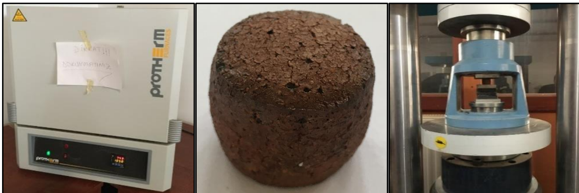
Şekil 4. Protherm Furnaces marka kül fırını, fırından çıkan hafif agrega, harç presi
