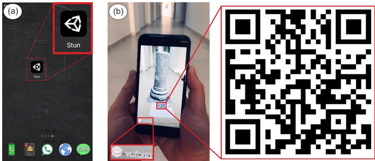
Şekil 7. Unity 3B oyun ve artırılmış gerçeklik geliştirme ara yüzü ile oluşturulmuş mobil uygulama (aplikasyon), uygulamada karekod aktifleştirence 3B modelin artırılmış gerçeklik ile sunulması ve görselleştirilmesi (b) ve Vuforia çevrimiçi platformunda oluşturulan tetikleyici.
