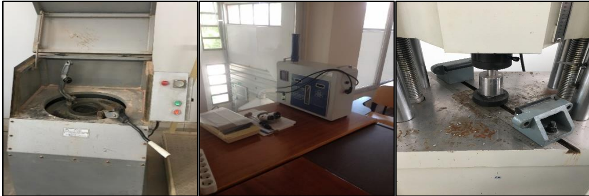
Şekil 3. Halkalı değirmen, blaine cihazı, karışımların silindir kalıpta farklı kuvvetler ile preslenmesi
