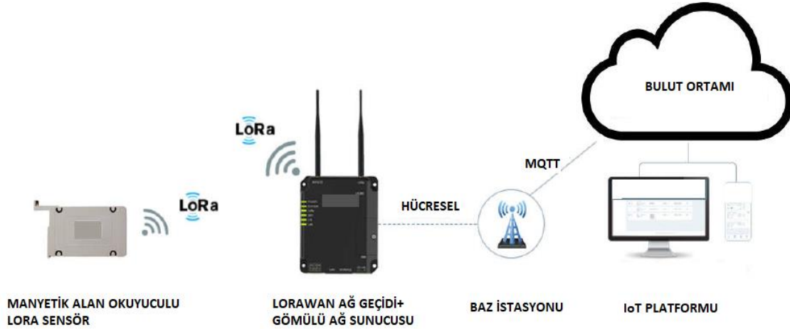
Şekil 5. LoRa Test Senaryosu Topolojisi
