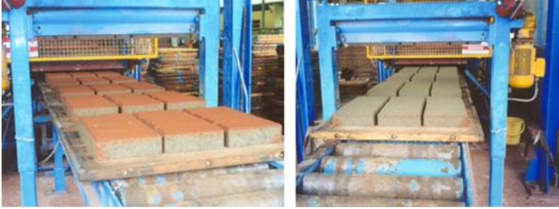
Şekil 1. Geri Dönüştürülmüş Agregadan Kaldırım Bloğu ("Environmentally friendly bricks ve blocks", 2019)
