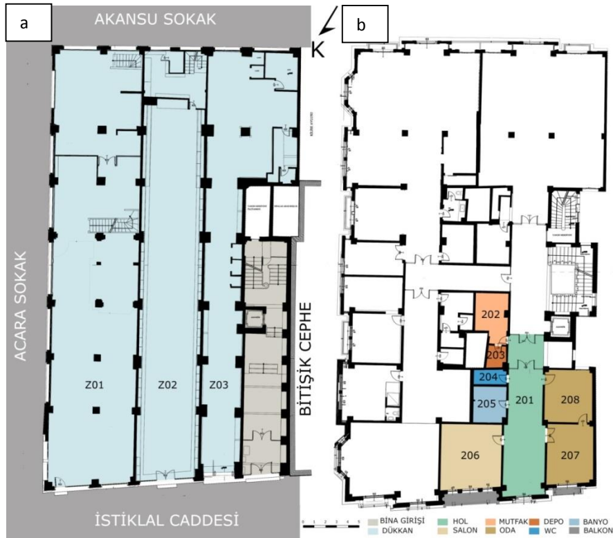
Şekil 8. Mısır Apartmanı, a) Zemin Kat Planı, b) 2. kat planı (Halil Onur Mimarlık röleve çizimi üzerinden hazırlanmıştır)
