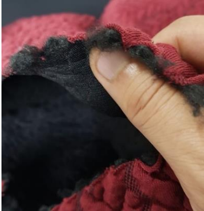
Şekil 6. Matelasse örme kumaşın katmanları ve jakarlı yuvarlak örme makinesi (Özcan, 2019)
