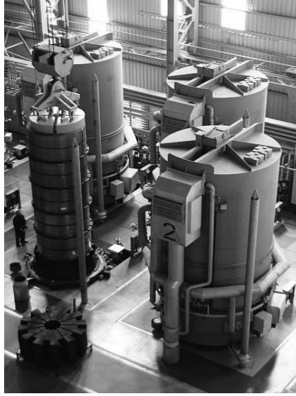
Şekil 7. Tavlama Fırınına Bobin Yüklemesi
