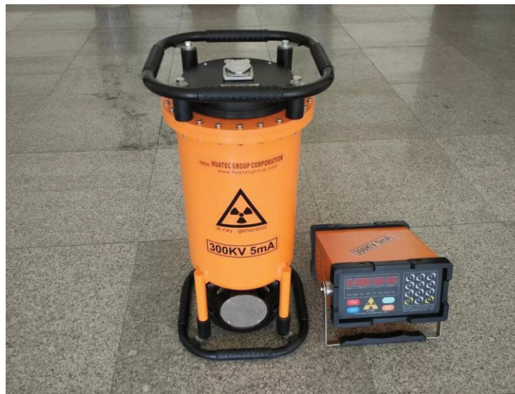
Şekil 1. Endüstriyel uygulamalarda kullanılan taşınabilir X ışını cihazı ve kontrol paneli (Huatec, 2021)
