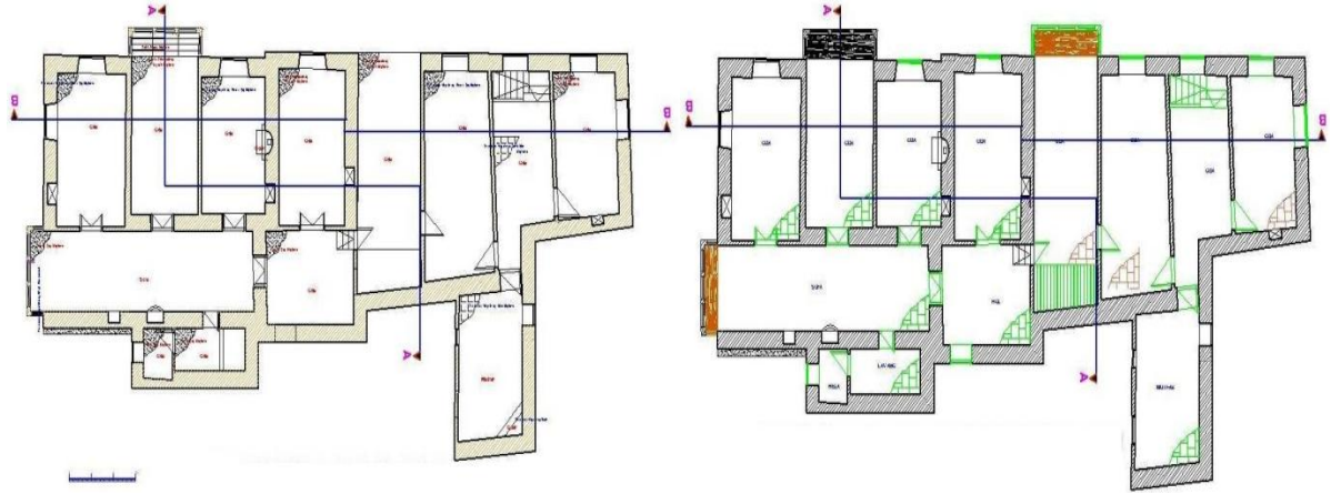
Şek. 23, 24: Sağır Müftü Konağı Üst Kat Rölöve-Restitüsyon Planı (Ş. Öztürk 2008)
