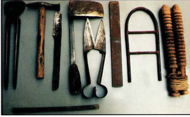
Resim 3: Nabant aletleri (İzmir Selçuk'lu Nabant Ahmet Ersoy'un nabant takımından) 1-Kerpeten, 2-Nallama, 3-Tırnak Keskisi, 4-Santranç, 5-Yele ve Kuyruk kıllarını kesmede kullanılan makas, 6-Tırnak Törpüsü, 7-Ağız ve Diş bakımında kullanılan ağırtık, 8-Yavaşa, 9-Diş Keskisi
