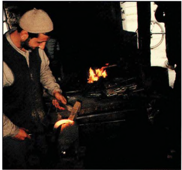
Resim 2: Manisalı Nalbant Mustafa'nın nalbanthanesinin nal yapma kısmından görünüş. Sıcak demire "U" şeklinin verilmesi
